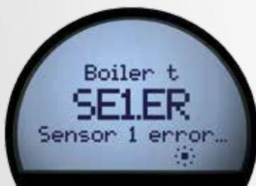
Se ocorrer um erro de sensor ou do dispositivo, uma luz de fundo vermelha ou branco piscando, texto de erro específico, e rolagem mensagens de erro ajudará a fornecer solução rápida de problemas.
