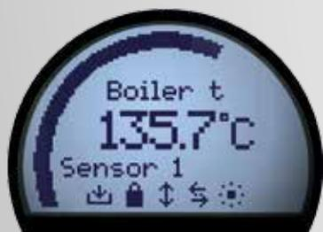
Através do vidro do invólucro, você pode facilmente monitorar o valor do processo, e o gráfico de barras radial indica a magnitude processo. Um tag personalizado para o dispositivo, tag do valor de processo e unidades de medida de campo tornar mais fácil a identificação do ponto processo apresentado.
